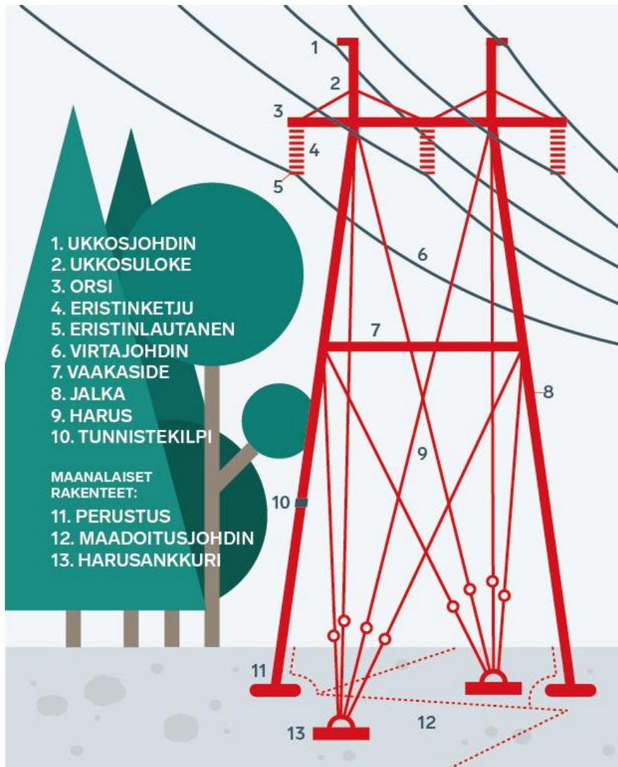
Kuva 3-9. Voimajohdon osat (Fingrid 2022a).
