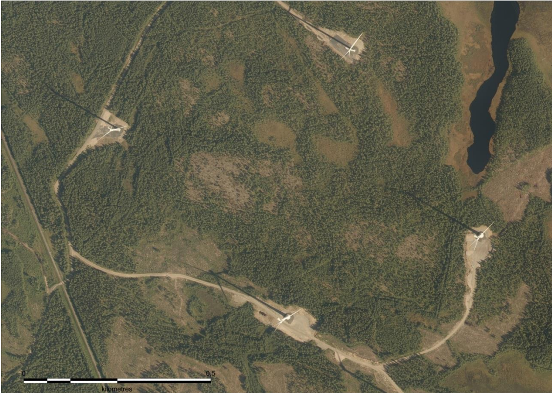
Kuva 2-8. Ilmakuvassa näkyy toiminnassa olevia tuulivoimaloita, huoltoteitä ja nostokentät. (MML, Ortoilmakuva)
